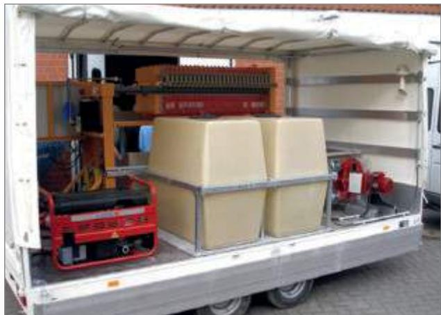
Von links: Stromerzeuger, Klarwassertanks, Schlamm-pumpe
