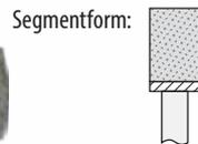
Zum Anfasen von Dehnungsfugen und Aufschneiden von größeren Rissen.
