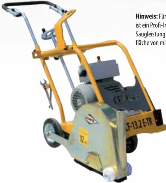
**Hinweis:** Für den Betrieb des CF-13.2 E-TR ist ein Profi-Industriestaubsauger mit einer Saugleistung von 240 m<sup>3</sup>/h und einer Filterfläche von min. 1,5 m<sup>2</sup> erforderlich.
