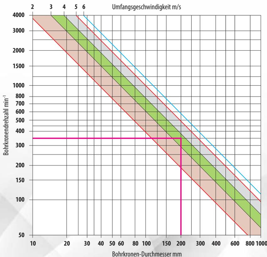
Bestimmen Sie die korrekte Drehzahl Ihres Bohrmotors in Abhängigkeit vom Bohrkronen-Durchmesser und der Härte des zu bohrenden Materials.
