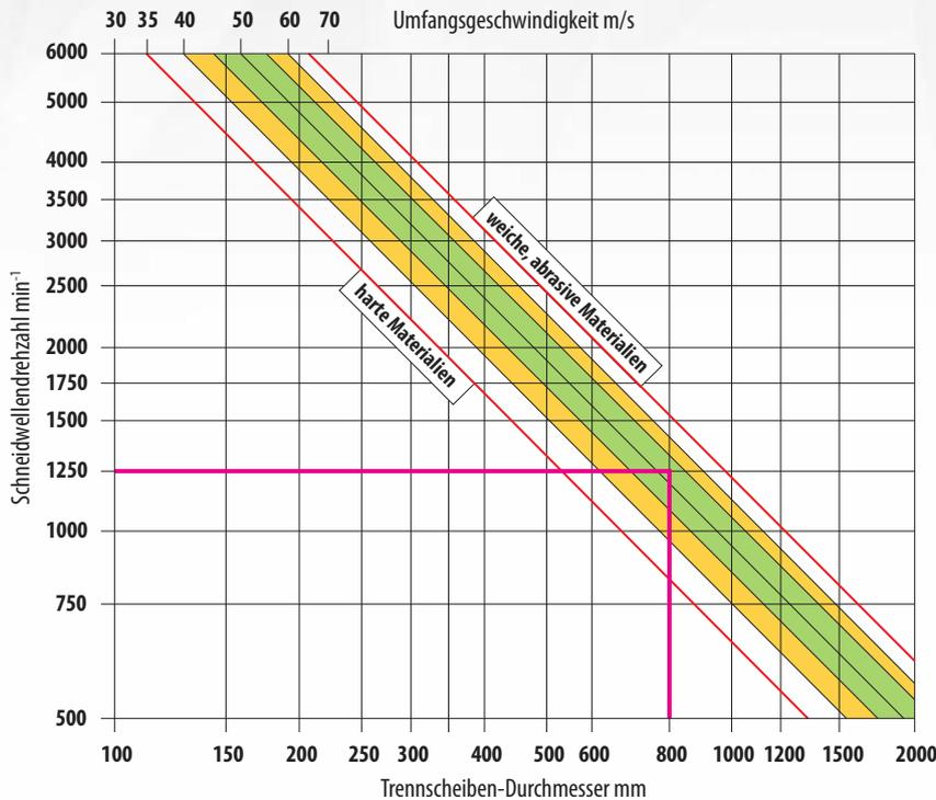
Ermitteln Sie die optimale Drehzahl an der Schneidwelle in Abhängigkeit vom Trennscheiben-Durchmesser und der Härte des zu trennenden Materials.
