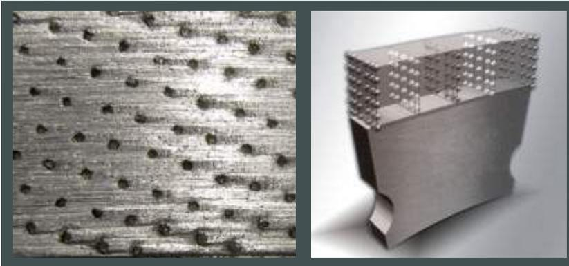
Diamantsegmente mit gesetzten Diamanten der 3. Generation in einem neuem Anordnungsverfahren. Durch die geometrisch exakte Verteilung sind immer annähernd gleich viele Schneiddiamanten im Eingriff. Das garantiert ein xzelligentes Schneiden mit sehr hoher Schnittgeschwindigkeit.
