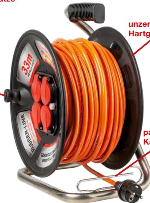
Doppelrohrgestell: Mehrteiliges verschweißtes Gestell aus Stahlrohr. Extrem robust und höchsten Anforderungen gewachsen. Korrosionsschutz durch Pulverbeschichtung. Ausgestattet mit ergonomischem Handgriff, Trommelfeststeller und langlebiger, funktionaler Kabelführung.
