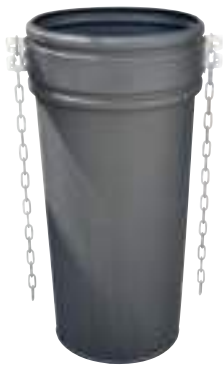
Kunststoff-Schuttrohr aus Polyäthylen mit 2 Ketten Länge: 1,10 m Ø oben: 528 mm Ø unten: 412 mm Gewicht: 9,50 kg
