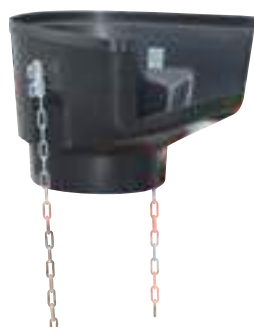
Kunststoff-Trichter aus Polyäthylen mit 2 Ketten Länge: 0,55 m Ø oben: 528 mm Ø unten: 412 mm Einfüllöffnung: Höhe: 0,25 m Breite: 0,65 m Tiefe: 0,70 m Gewicht: 6,00 kg
